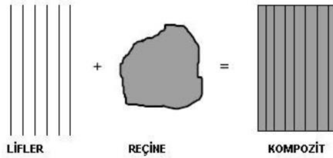
Şekil 1.5: Lif (takviye) ve reçine (matris) yapılarından oluşan kompozit malzeme [1]
